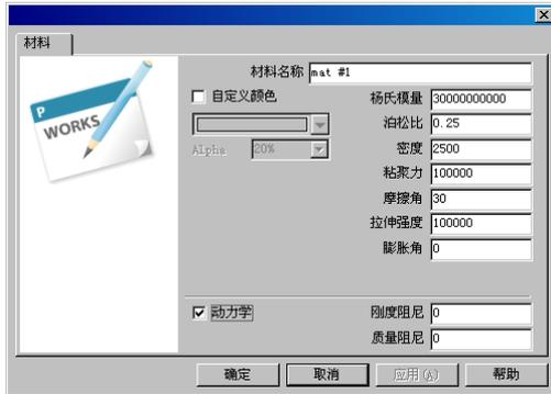
图 4.39 材料设置对话框
