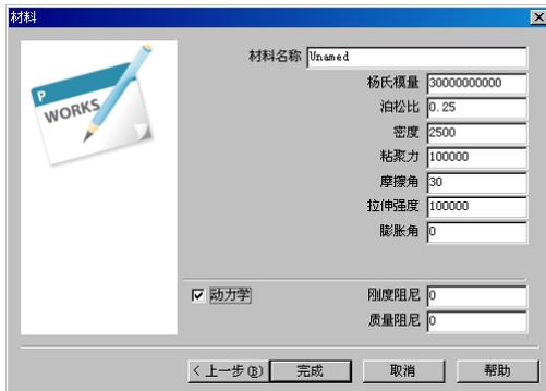
图 4.16 界面材料参数设定对话框
