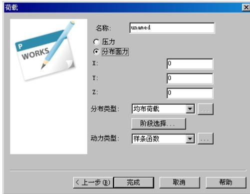
图 4.28 面荷载参数设置对话框
